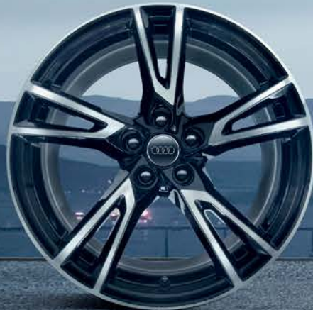
19 英寸 5 辐 V 型铝合金轮辋， 石墨灰色，部分抛光 尺寸：8.0Jx19 轮胎：235/55 R19
